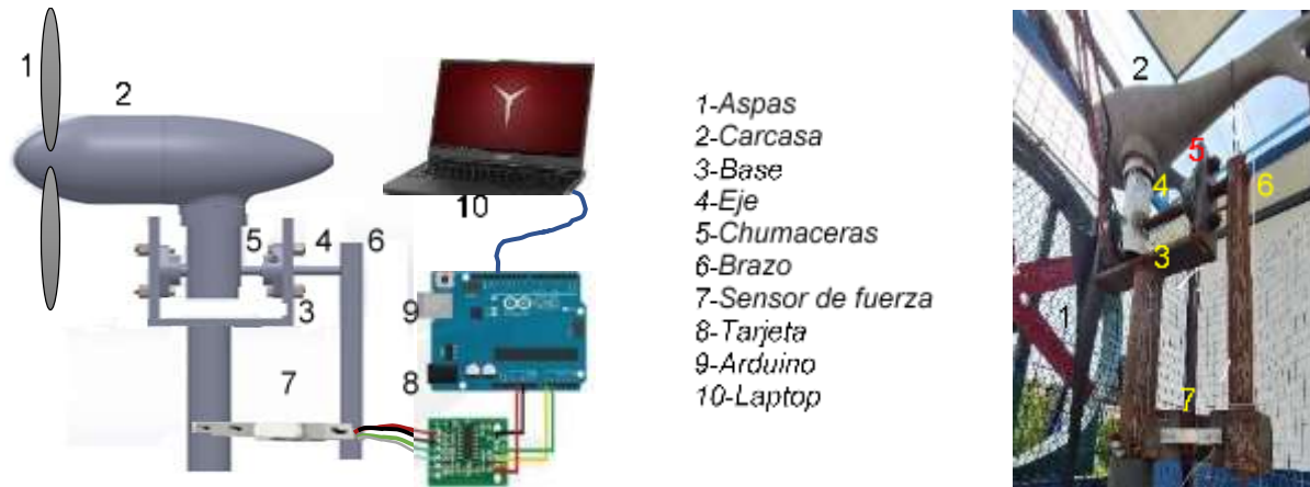
a) Figura 1. Circuito de adquisición de datos a) y prototipo del sensor de torque b)
