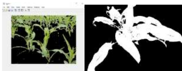
Figura 1. a) Imagen de maíz segmentada (izquierda), b) imagen de maíz binarizada (derecha)
