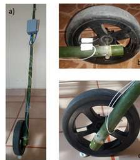
Figura 2. Prototipo: a) Diseño final, b) Sensor magnético, c) Posición de operación
